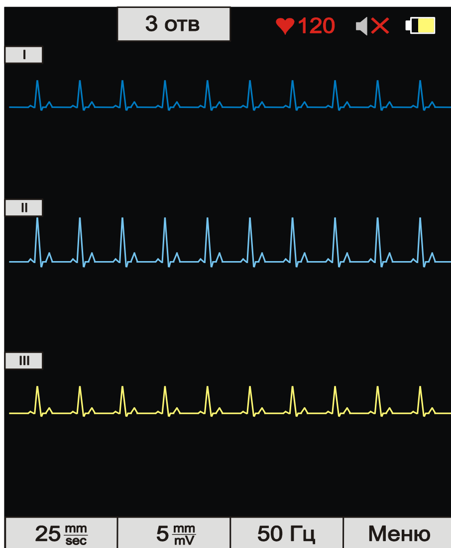
Рисунок 6 – Пример отображения трех отведений на дисплее в режиме мониторинга ЭКГ
